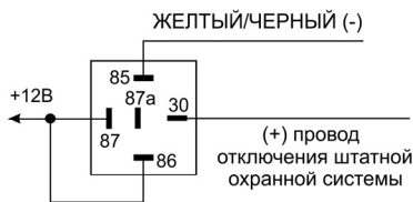
Подключение к (+) проводу снятия штатной сигнализации с охраны с использованием дополнительного реле
