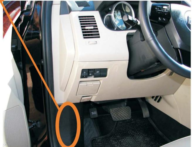
PL - KOLEJNOŚĆ PODŁĄCZANIA PRZEWODÓW: MASA, +12 V, USTAWIĆ NUMER PROGRAMU DLA DANEGO AUTA, PODŁĄCZYĆ CANL I CANH.
