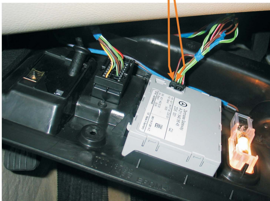
MODUŁ GATEWAY (nad nogami kierowcy) GATEWAY CONTROLLER (above driver's legs) МОДУЛЬ GATEWAY (над ногами водителя)
