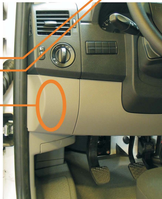
MODUŁ STERUJĄCY SAM (z lewej strony kolumny kierownicy) SAM CONTROLLER MODULE (left side of steering column) УПРАВЛЯЮЩИЙ МОДУЛЬ SAM (с левой стороны рулевой колонки)
