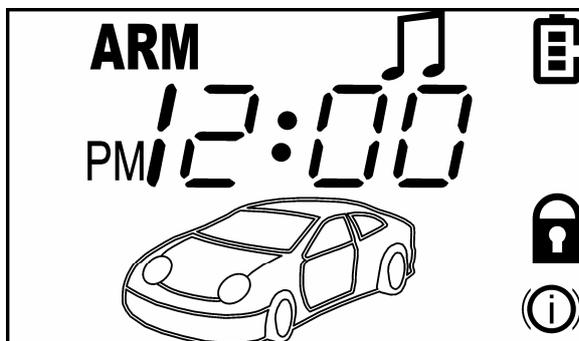
**Примечание.** Если система срабатывала после включения охраны, то из соображений безопасности функция «Safe Start» будет отменена и дистанционный или автоматический запуск автомобиля **не будет более возможен**. Иконка
