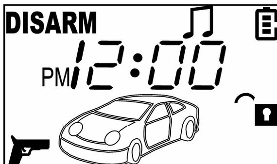
Через 30 секунд после включения режима Anti-HiJack включится сирена системы и начнут мигать указатели поворота автомобиля. Если в этот момент зажигание будет выключено - система немедленно заблокирует двигатель автомобиля.
