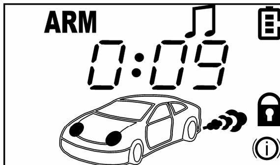
5. Двигатель будет продолжать работать на холостом ходу под управлением системы дистанционного запуска в течение запрограммированного времени. Если в течение этого времени Вы не снимете систему с охраны и не отключите данную функцию, то двигатель автомобиля будет автоматически остановлен и система перейдет в стандартный режим охраны.
